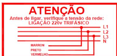
Adhesivo designado a la tensión eléctrica, encontrado en la extremidad del cable eléctrico de alimentación de L2 la máquina.
