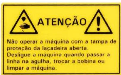
Adhesivo de advertencia cuanto al riesgo de perforación / corte en las manos y dedos en contacto con la lanzadera y demás elementos.
